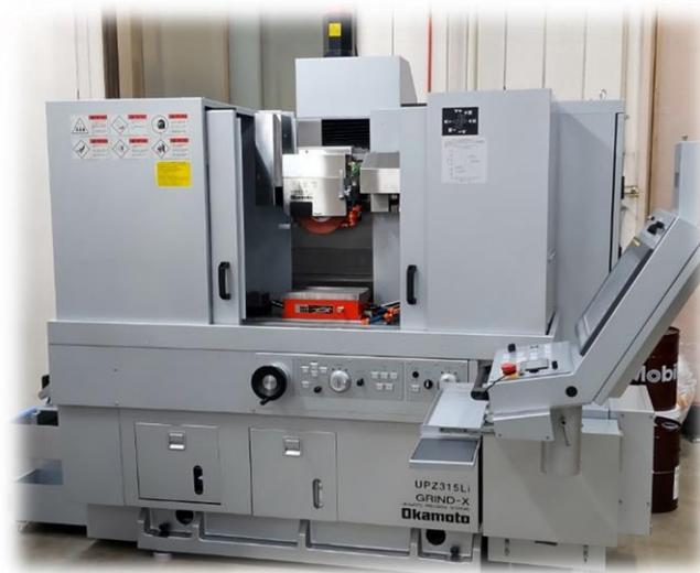
株式会社岡本工作機械製作所製 CNC 超精密成形研削盤
